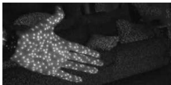
Figura 5. Luz infrarroja proyectada sobre una superficie.
