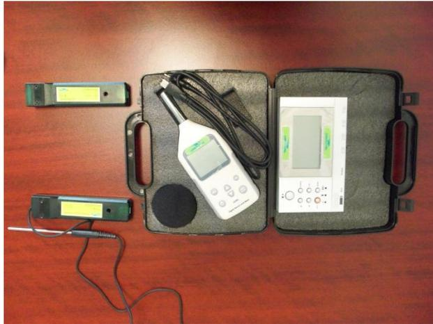
Interface de comunicación y sensores para medición de ruido, temperatura e iluminación
