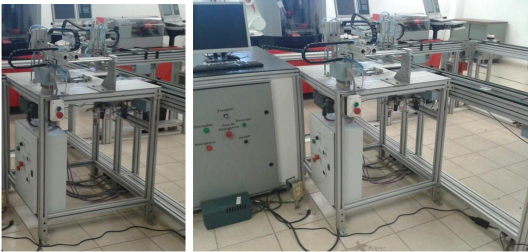
**Figura 3.- Estación neumática para el ensamble de discos compactos, cuenta con una posición para colocar la caja, otra para el disco, posee un mecanismo de colocación automatizada de discos y de cerrado de la caja y finalmente la manipulación de la misma para ubicarla en el pallet de transporte hacia la banda.**
