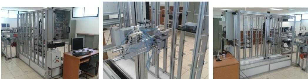
**Figura 5.- Sistema Automatizado de Almacenamiento y Surtido.**
