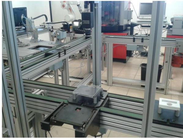
**Figura 8.-** Unidad de verificación equipada con una cámara fotográfica que compara imágenes y determina si se acepta o se rechaza el producto.
