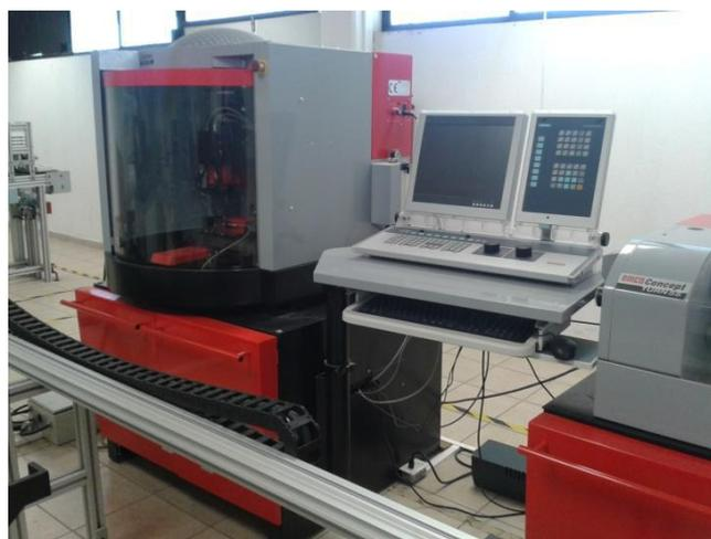
**Figura 6.- Fresadora Marca EMCO Concept modelo MILL 55**
