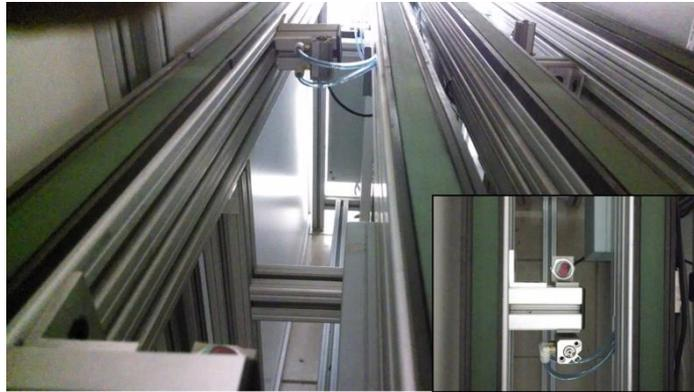
Vista a detalle de bandas transportadoras y dispositivos de paro automático (recuadro).
