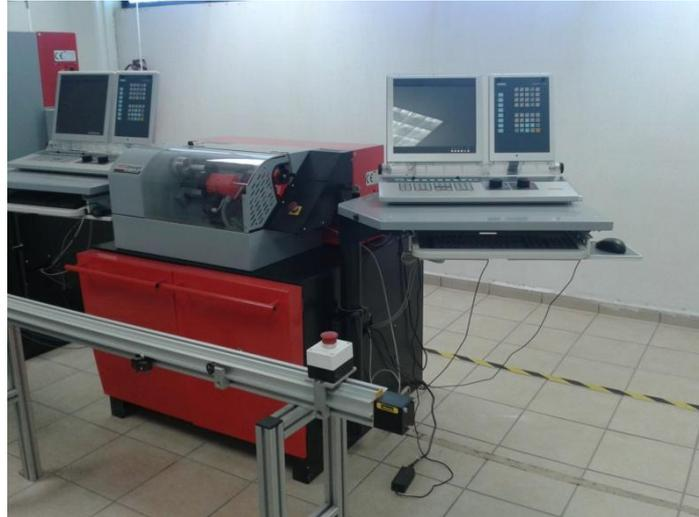
**Figura 7.-** Torno EMCO Modelo TURN 55
