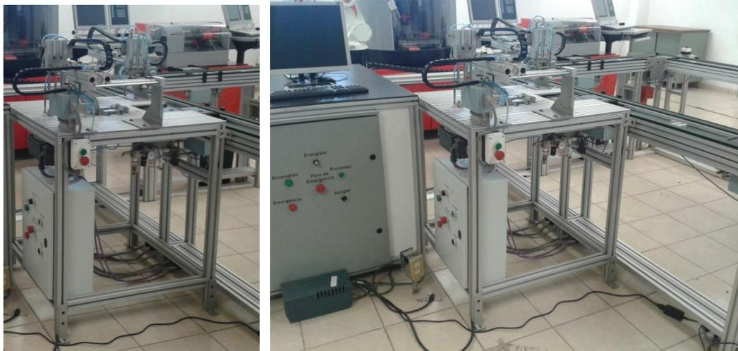
Estación neumática para el ensamble de discos compactos, cuenta con una posición para colocar la caja, otra para el disco, posee un mecanismo de colocación automatizada de discos y de cerrado de la caja y finalmente la manipulación de la misma para ubicarla en el pallet de transporte hacia la banda.
