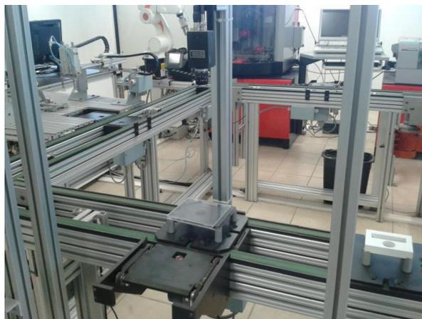
Unidad de verificación equipada con una cámara fotográfica que compara imágenes y determina si se acepta o se rechaza el producto.
